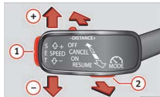
Pilt 186 Kiirushoiduri ja -piiriku lülitus hoob (kolmas) roolisambal vasakul »
