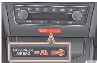
Pilt 103 Juhinaabri turvapadja väljalülitamise märgutuli armatuurlaua keskel
