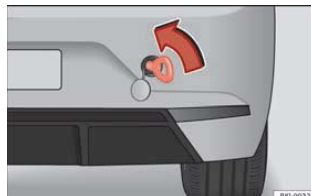
Pilt 108 Kohale keeratud pukseeraas tagakaitseraua paremal otsal
