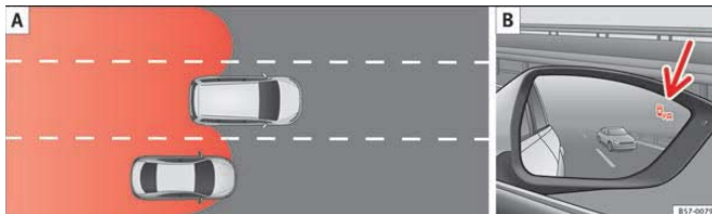
Pilt 204 [A] Möödasõidujärgne olukord, kui oma rajale naasja taga paremal on teine auto, [B] pimenurgaabisti näit paremas peeglis
