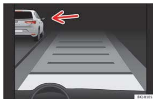
Pilt 198 Armatuurlaua: ACC töötab, kõrvalrajal tuvastati sõiduk
