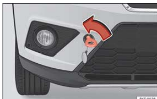
Pilt 106 Kohale keeratud pukseeraas esikaitseraua paremal otsal
