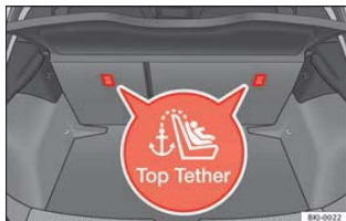
Pilt 31 Ülarihma kinnitusaasad taga-istmeleeni tagaküljel
