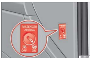
Pilt 102 Juhinaabri turvapadja väljalülitamise lukklüliti
