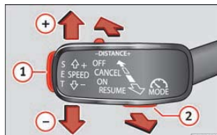
Pilt 51 Roolisambal vasakul võib olla ka kolmas lülitushoob kiirushoiduri ohjamiseks
