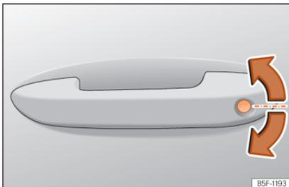
**Fig. 89** Driver door handle: locking cylinder.
