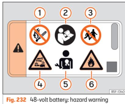
Fig. 232 48-volt battery: hazard warning
